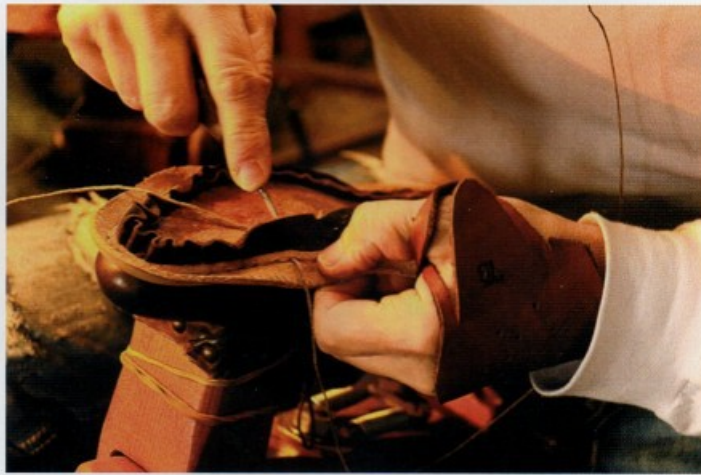
甲革、中底、コバの3つを縫い合わせる工程。すくい針とよばれる専用針で穴を開けた後に糸を通す。厚みがあるため、糸を引くのにかかる力を要する。
